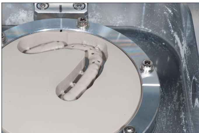
Abb. 3: Digitaler Workflow: Gefräste Struktur im Juvora PEEK Blank in der Fräsmaschine (Foto: B. Siewert).
