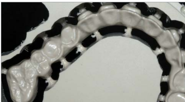
Abb. 15 und 16: Im CAD/CAM-gestützten Verfahren erarbeitetes Gerüst (links: basal, rechts: okklusal), (Juvora Dental Disc).
